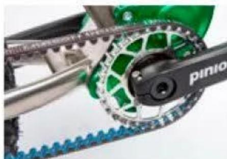
Üppige 636% Gesamtübersetzung: die Pinion-P1.18-Getriebebeschaltung.
