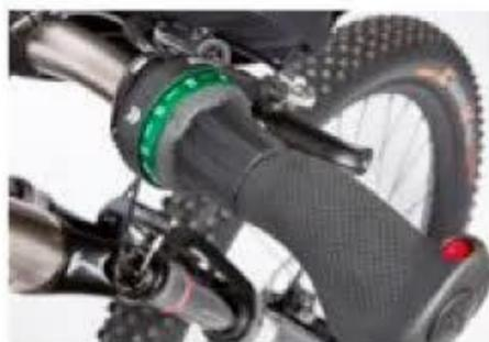
Locker aus dem Handgelenk schalten per Pinion-Drehgriff.
