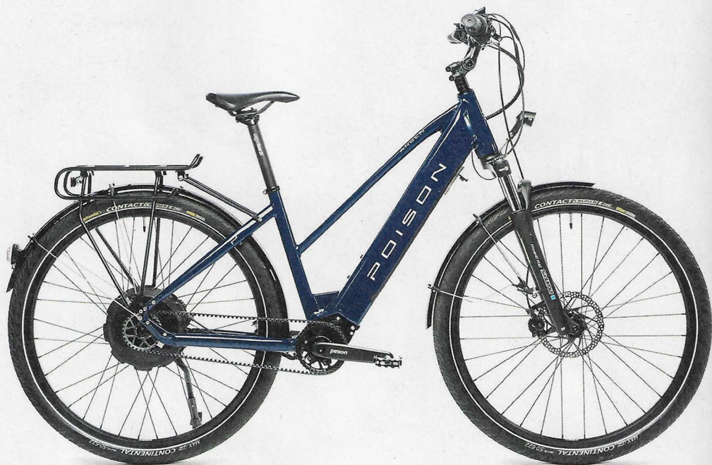
Starke 600% Gesamtübersetzung: Pinions Tretlagergetriebe P1.12.
