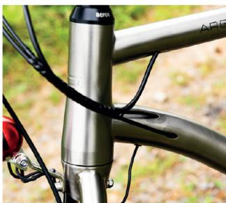
Schnell, gut griffig, preiswert: der Allterrain-Reifen Hurricane. Unten: kräftiges Steuerrohr, und innen geführte Leitungen.
